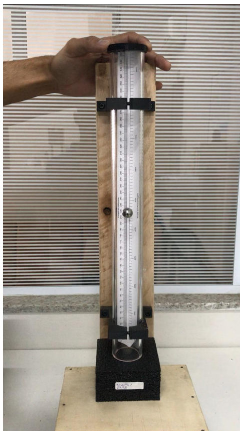
Figura 22 – Teste para determinação da resiliência da espuma de polietileno.
