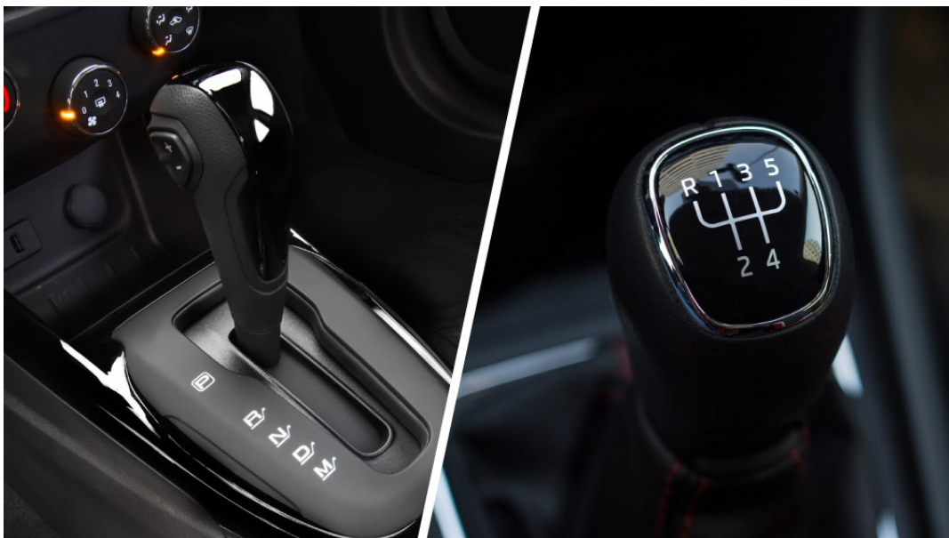
Figura 3 – Câmbio manual x Câmbio automático
