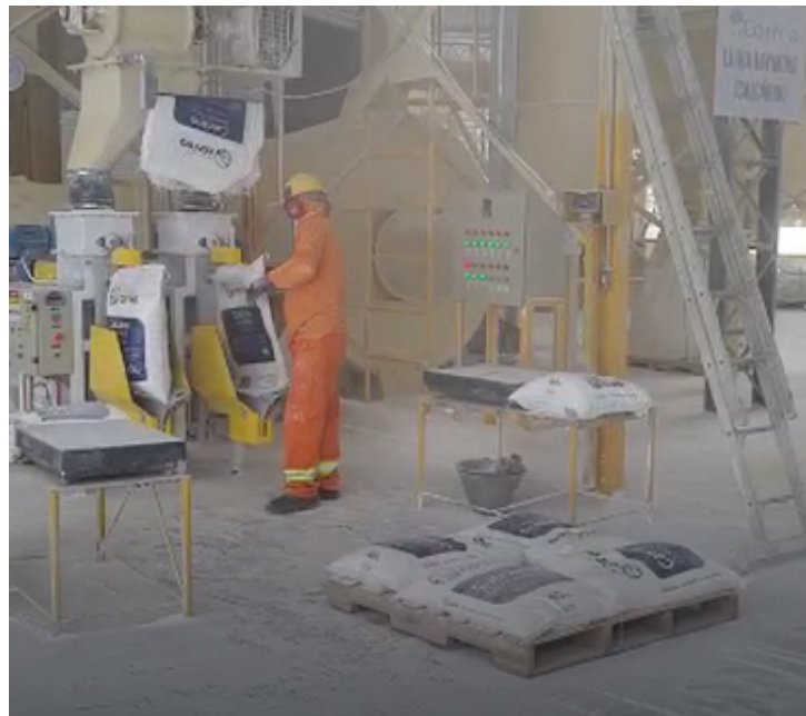
Figura 17 – Atividade 2: Acionar o botão da ensacadeira
