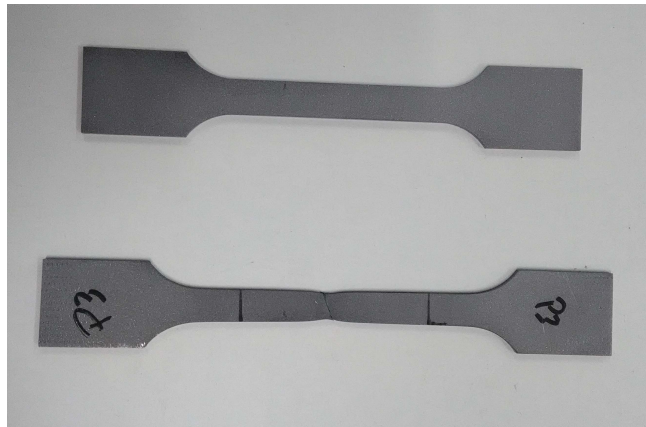
Figura 3 – Exemplo de corpos de prova usados em ensaios de tração, acima, um provete antes de ser ensaiado e a baixo um já ensaiado.
