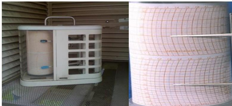
Figura 18: Termohigrógrafo
