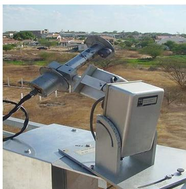
Figura 23: Pireliômetro de compensação de Ångstrom
