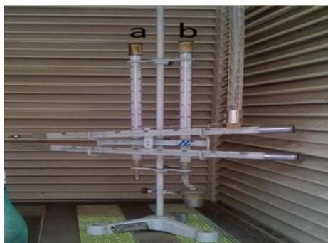
Figura 16: Psicômetro: bulbo seco (a) e bulbo úmido (b).
