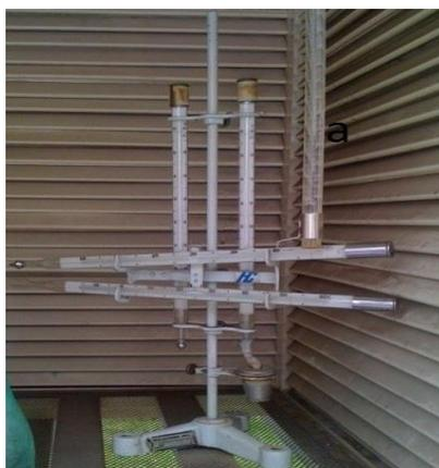
Figura 19a: Evaporímetro de Piche
