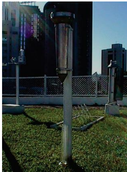
Figura 29 – Pluviômetro Ville de Paris Fonte: Vianello (2011)
