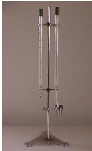
Figura 7 – Psicrômetro (bulbo seco e bulbo úmido) não ventilado.
