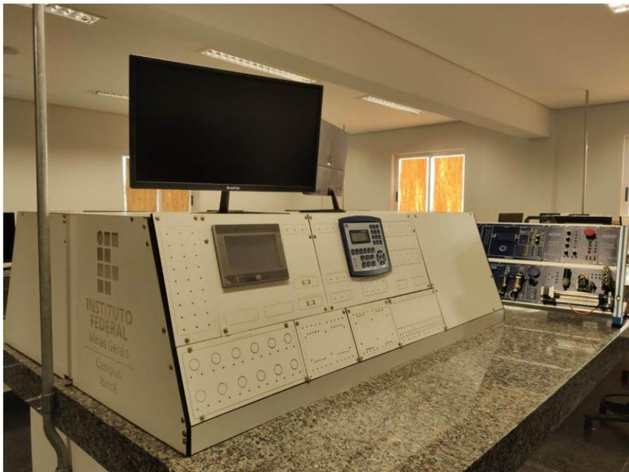
Figura 10 - Bancada didática de automação industrial. Fonte: autor.
