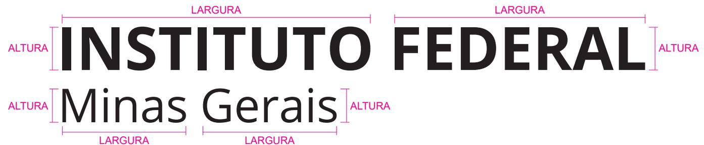
Letras ou marca do IFMG feitas em ACM (alumínio composto) 3 mm de espessura, recortadas eletronicamente e fixadas em fachada.
