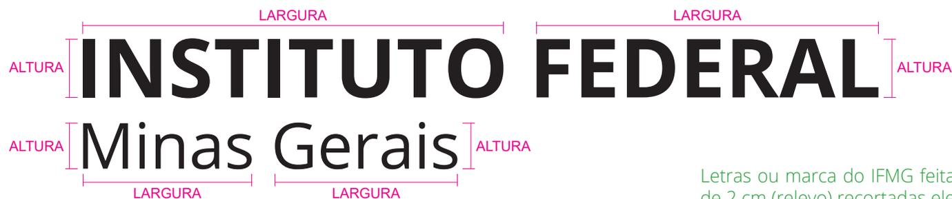
Letras ou marca do IFMG feitas em PVC expandido, espessura de 2 cm (relevo) recortadas eletronicamente, pintadas e fixadas em fachada.
