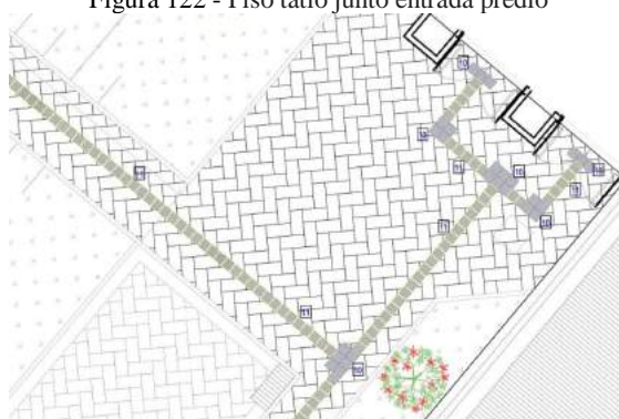
Figura 122 - Piso tátil junto entrada prédio
