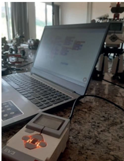
Figura 6 . – Exemplo de comunicação entre o bloco EV3 com o software EV3 Classroom
