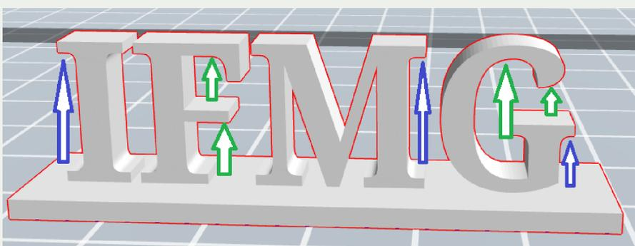
Figura 17: Exemplos de Seções Suspensas no modelo 3D
