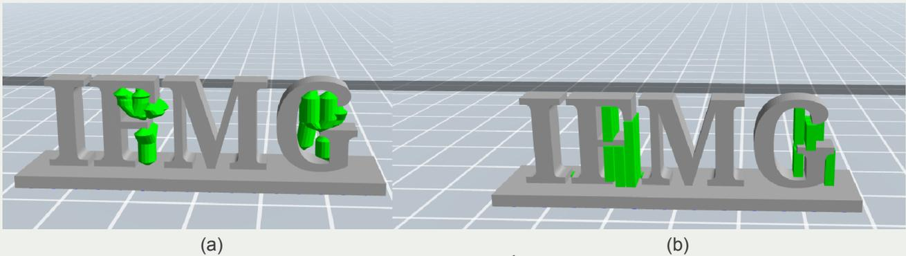
Figura 18: Exemplos de Suportes gerados nas configurações Árvore e Linear
