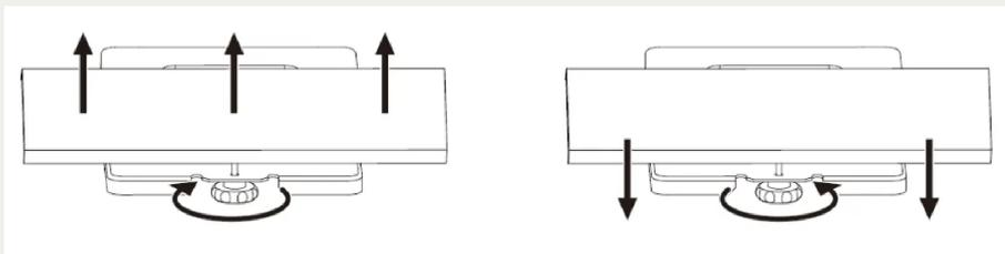
Figura 12: Ajuste dos parafusos de nivelamento
