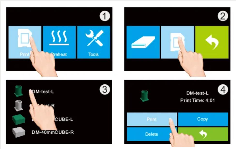
Figura 24: Painel da Impressora – Processo de impressão
