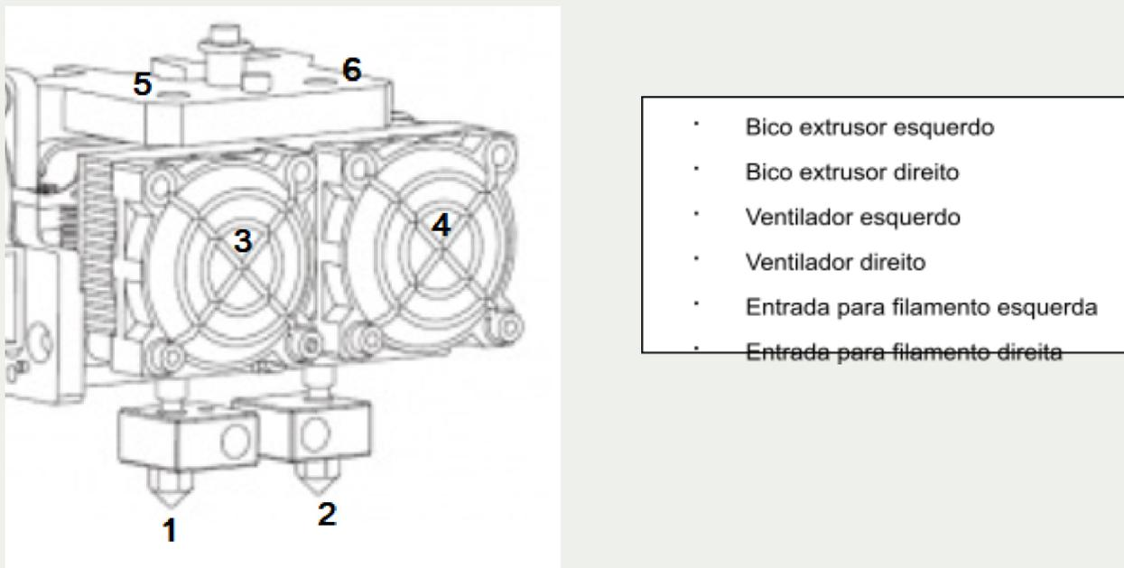
Figura 6: Detalhamento do Bloco Extrusor da Impressora 3D
