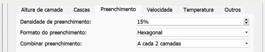
Figura 21: Detalhe da aba Preenchimento na Caixa de Diálogo Imprimir
