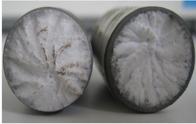
**Figura 1 - Fratura Frágil na resina SR101.**
