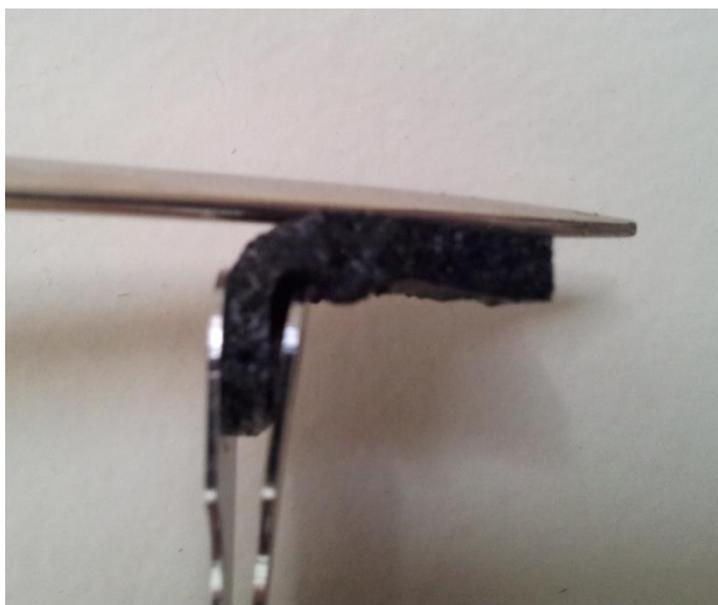
**Figura 3 - Exemplo de dobramento aplicado ao material**
