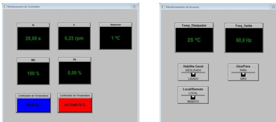
**Figura 3** – Telas da aplicação supervisoría desenvolvida em Elipse SCADA: a) Tela do monitoramento e controle da temperatura do ar de secagem; b) Tela do monitoramento e controle de vazão por meio do inversor.
