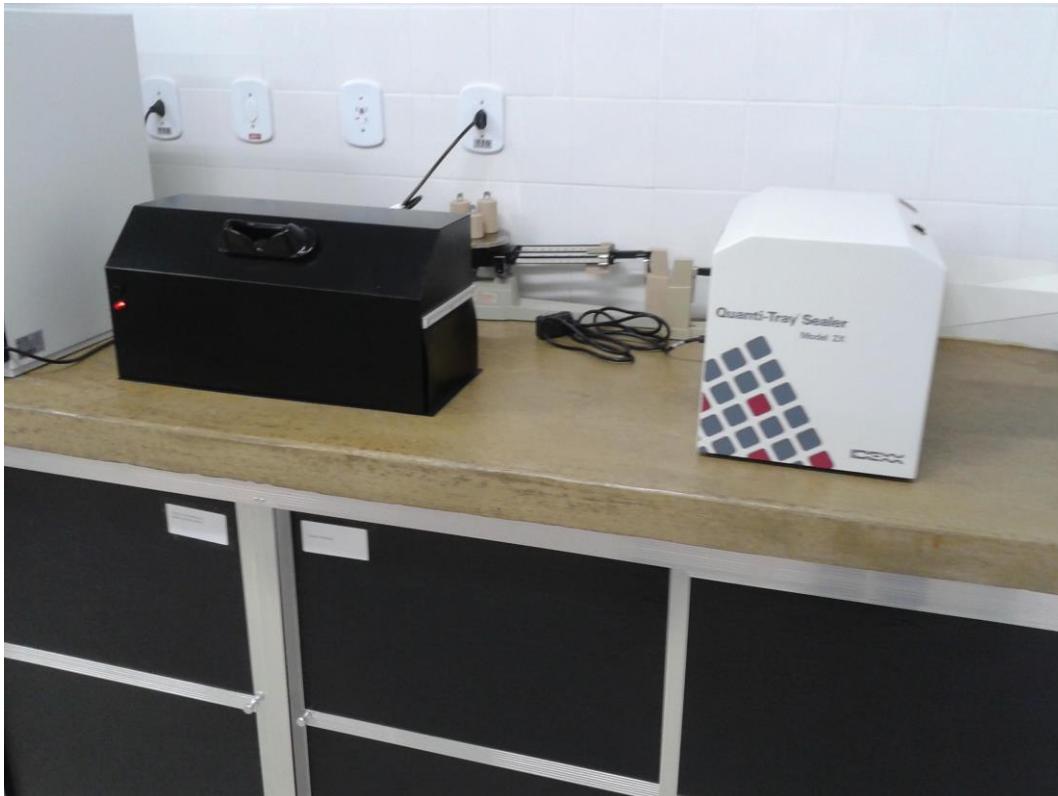
Figura 2 – Câmara escura (à esquerda) e a seladora da cartela de coliter (à direita).
