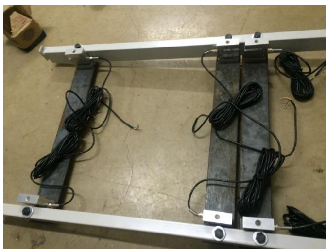
Figura 1 : Exemplo de como foram fixadas as células de cargas nos perfis e logo após na esteira.
