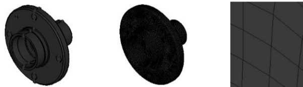
Figura 3: Modelo convencional do cubo de roda comercial. Fonte: Autor.
