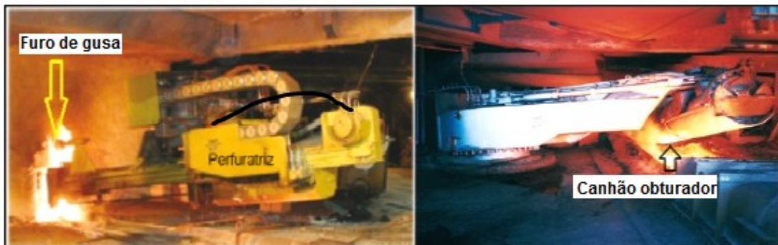
Figura 2: (a) Perfuratriz no momento da abertura do furo de corrida (TMT), (b) Canhão de injeção de massa refratária (TMT).
