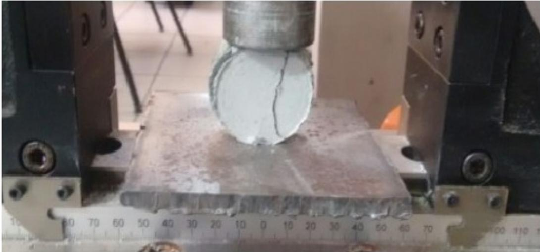
Figura 4 – Amostra após o ensaio de compressão diametral.
