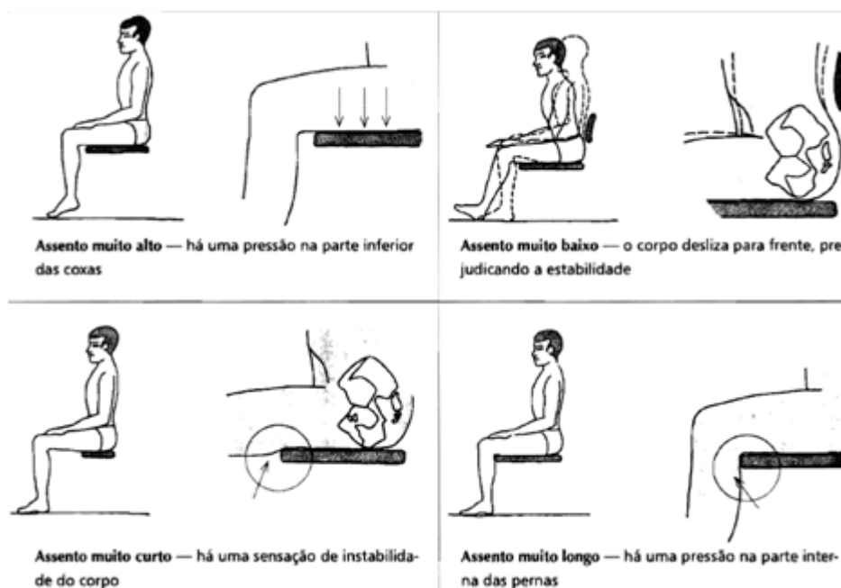
Figura 2 - Principais problemas provocados por erros no dimensionamento de assentos
