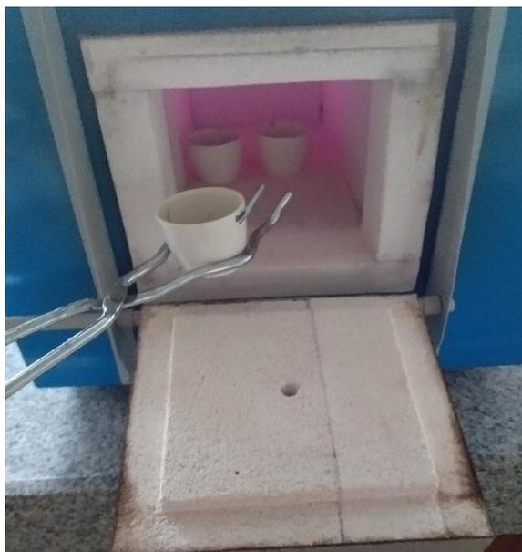
**Figura 1: Forno mufla utilizado na calcinação das amostras.**
