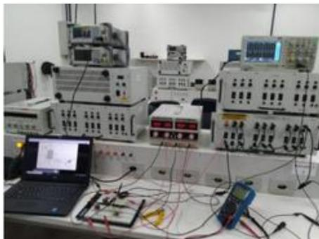
Figura 6: Circuito CC/CA montado no laboratório
