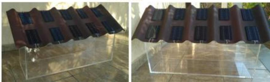
Figura 2: Telha Solar Fotovoltaica construída
