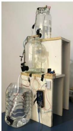
Figura 1: Sistema didático de tanques acoplados.
