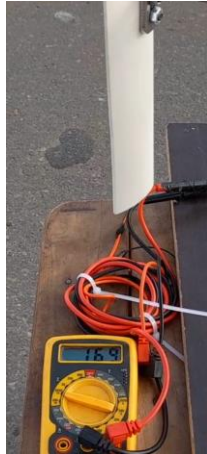
Figura 8: Registro de tensão gerada durante o terceiro teste em vias públicas. Fonte: Autores
